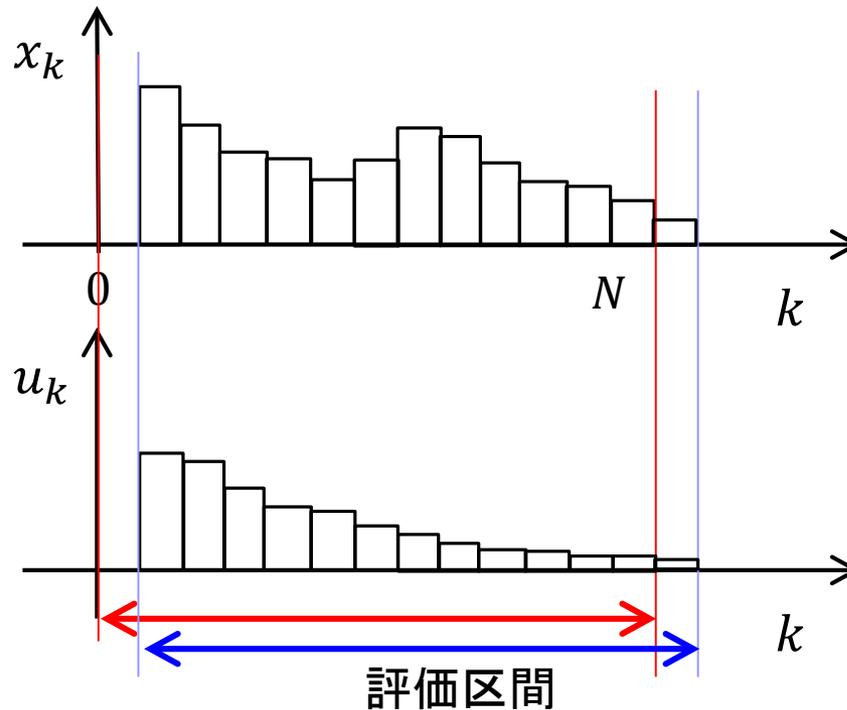
評価区間が現時点から見て時間方向(未来)に向かって後退するため、**Receding Horizon Control** と呼ばれる。
