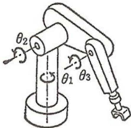
しかしヒトの腕を模した器用さ (障害物の裏側に回り込んで作業する等) を求めると、このようなタイプが望ましいことになり、各軸動作の干渉、非線形性は避けられない。
