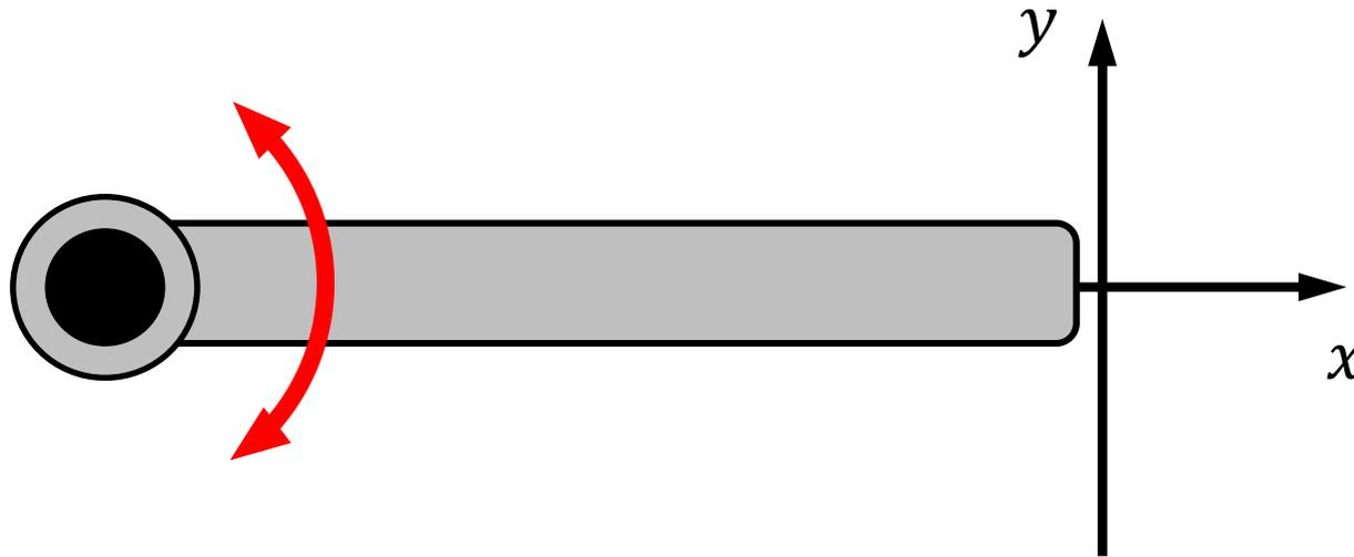
根本の回転角  $\theta$  が微小であるとき, 先端の  $y$  方向の移動量は  $r\theta$
