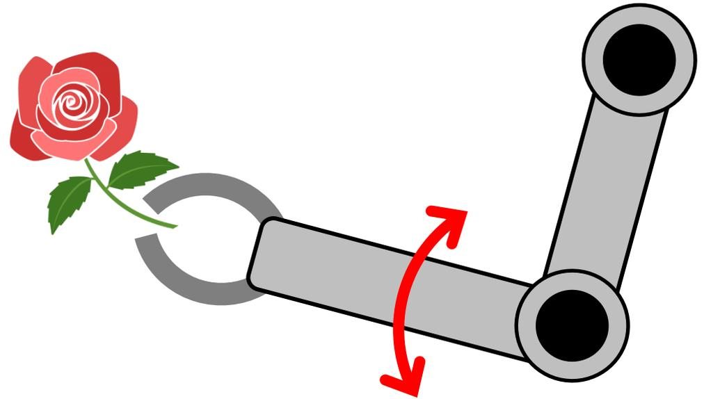
二重振子の軸にモータを取り付けて強制的に駆動すれば, これは2リンクマニピュレータである.
